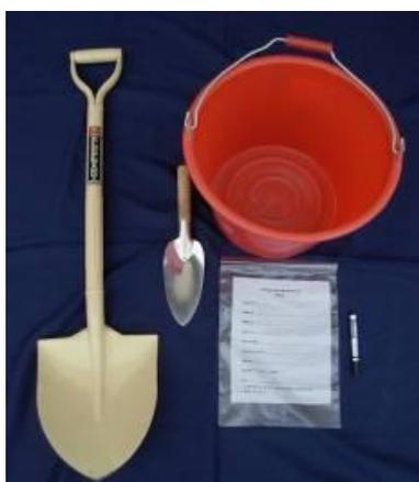
圖 1. 土壤採樣工具: 土鏟、移植鋤、乾淨塑膠桶、採樣袋、油性筆等
